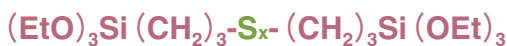
図20 シランカップリング剤を介したシリカとエラストマー分子の結合
