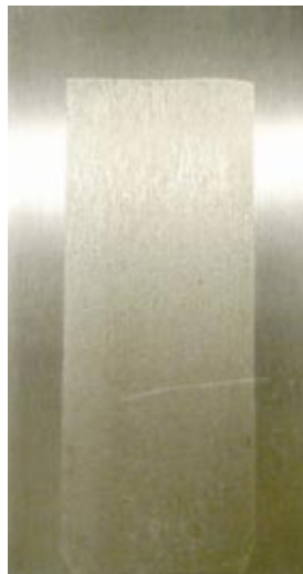
280℃×2時間エージング後の糊残りの状態(被着体:ステンレス板)
