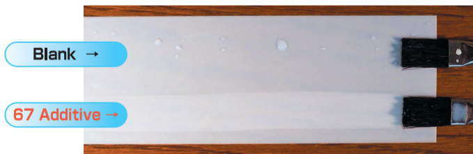
PTFEフィルムへの水系塗料塗布
